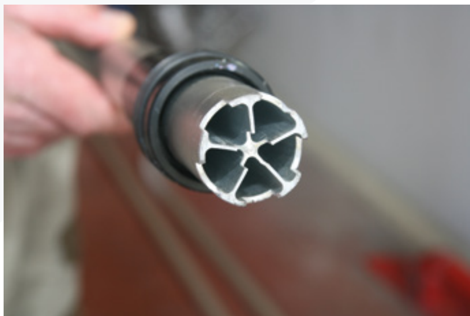
Røret er avstivet med fem kammer som gjør at man har full vannføring uansett om røret blir bøyd.
